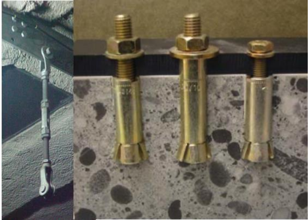
الشكل (٨-٩) أجهزة الاستبدال النموذجية (يسار)؛ تحجيم المثبتات الميكانيكية (يمين).
