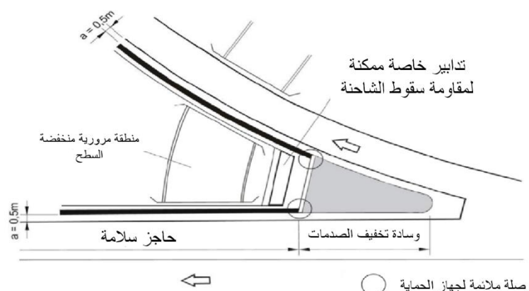
الشكل (٦-٧) الاستخدام النموذجي لوسائد تخفيف الصدمات على جزر المرور الفاصلة على الجسور (FGSV, 2009).
