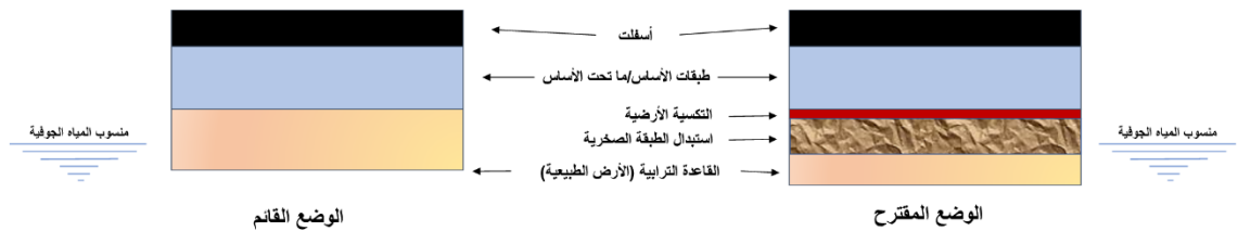
الشكل (٢-٤) تدابير التخفيف حيث يكون منسوب المياه الجوفية تحت منسوب الأرض الطبيعية/غشاء التكسية الأرضية (Jeddah Municipality, 2020).
