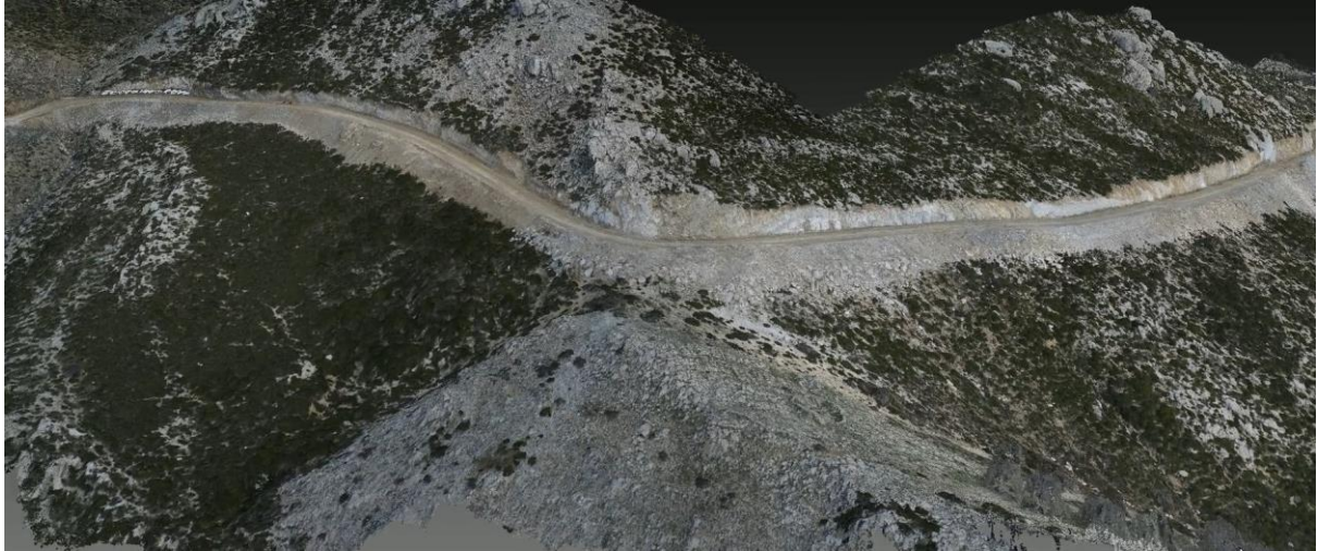
الشكل (٥-٢) السحابة النقطية المتولدة من المسح الجوي.
