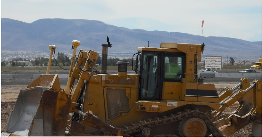
الشكل (١٩-١) مثال على التوجيه الآلي للمعدات المستخدم في موقع إنشاء (DOT, 2013).
